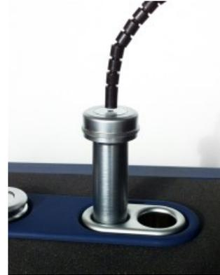
3. Coloque el micrófono de referencia (1) apuntando verticalmente hacia abajo y céntralo a 1 o 2 milímetros por encima del micrófono de medición del acoplador (3).
